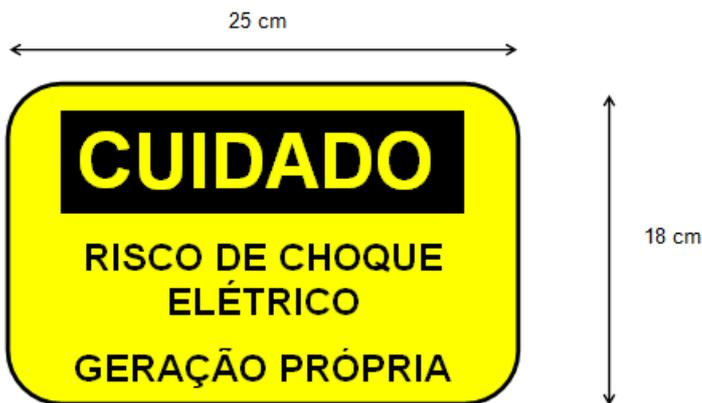
Figura 10 – Modelo de placa de advertência para o padrão de entrada
